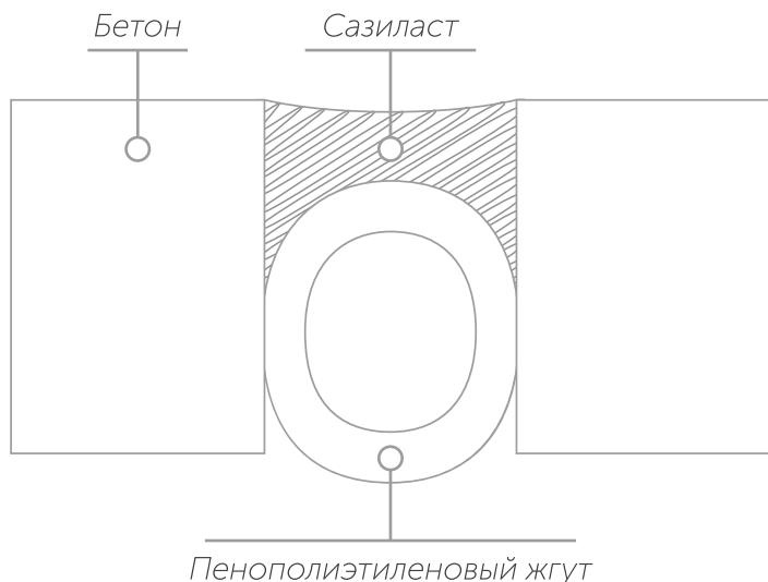
Жгут устанавливают насухо в горизонтальные и вертикальныестыки со стороны наружной поверхности стены в качестве подосновы под герметики.
